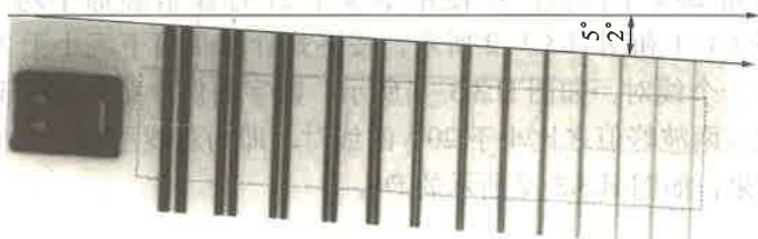
图 H.1.2 数字图像中双线型像质计的图像
