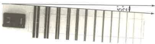
图 F.2.2-1 双线型像质计透照图像
